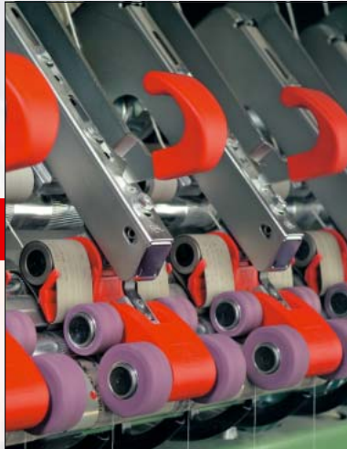
EliTe® CompactSet-S para continuas de hilar fibras cortas
