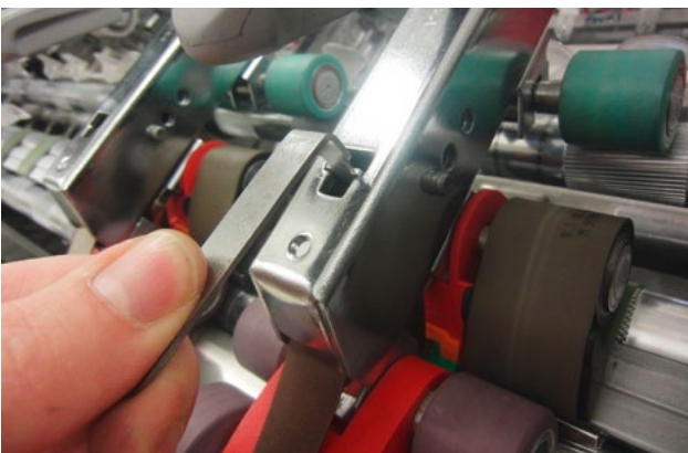
Abb. 12: Falsche Position der EliSpring – Prüflehre zu hoch
