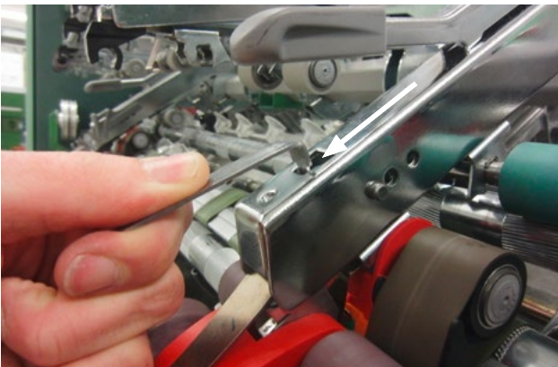
Abb. 11: Korrekte Position der EliSpring
