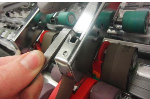
Şek. 12: EliSpring'in yanlış konumu – kontrol mastarı çok yukarıda
