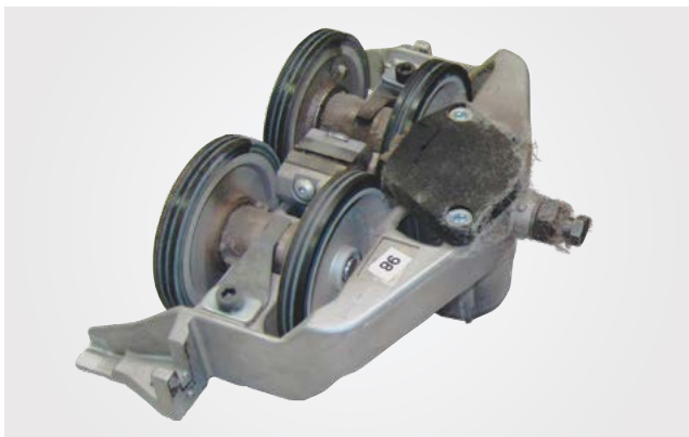
Comparación del rodamiento con ProFiL Cartridge (a la izqda.) con rodamiento de aceite (a la dcha.) después de 8 semanas de operación hilando algodón 100%, Ne 24 con 120000 rpm en la misma máquina
